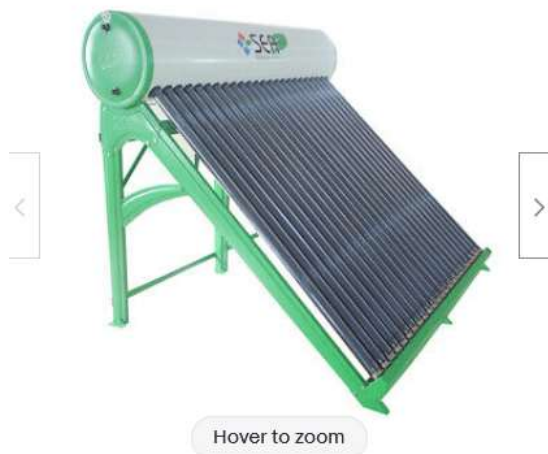
Calentador de agua solar pasivo (por termosifón), con tanque no presurizado
