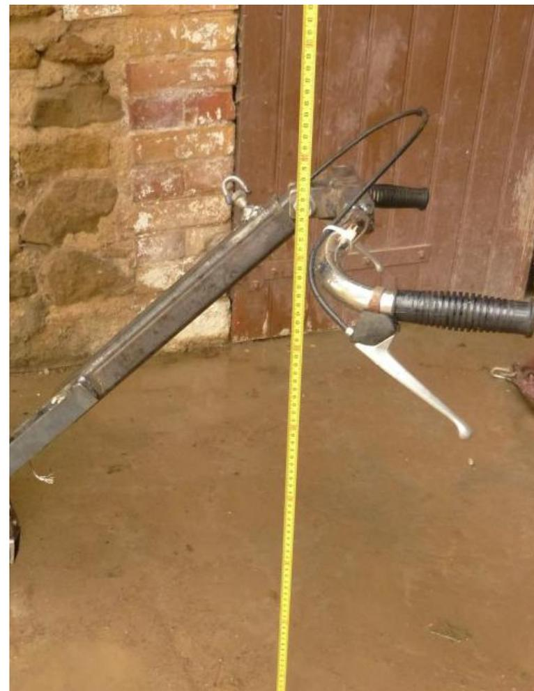
*Sur le 1<sup>er</sup> prototype, le guidon avait été récupéré sur un vieux vélo. Le système de poignée, gaine câble de frein a été remplacé par une tringle rigide avec une chaînette pour une meilleure tenue dans le temps du mancheron.*
