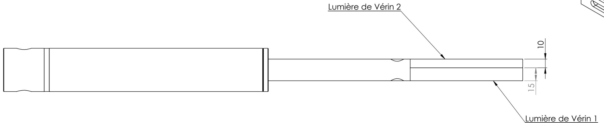
**Souder le renfort O3 et la lumière après avoir sorti au maximum la tige de vérin, et après l'avoir protégée des projections de soudure. Laisser refroidir le tout avec la tige sortie.**
