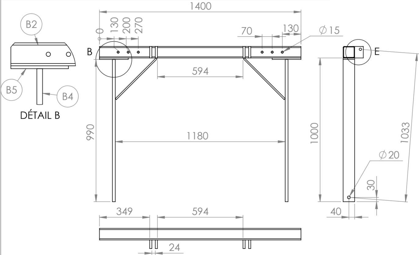
**ATTENTION** : L'assemblage du bâti doit se faire en ayant emmanché les bras horizontaux (E), afin d'éviter que la pièce B2 se cintre à cause des cordons de soudure unilatéraux
