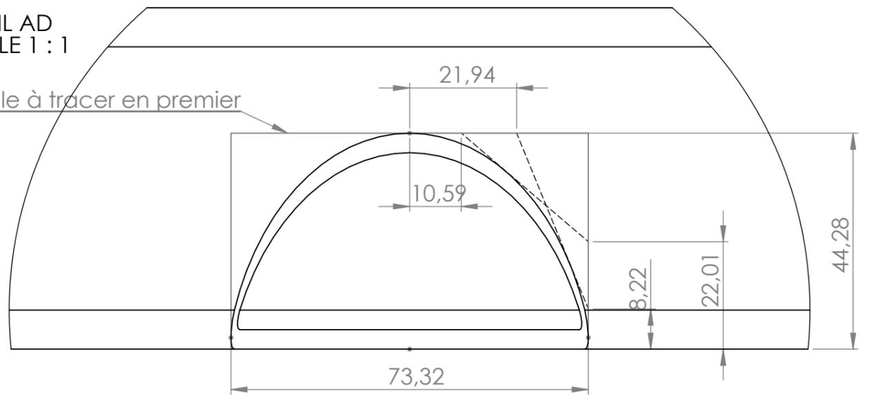
**Indications pour tracer les tangentes permettant de s'approcher de la forme voulue**
